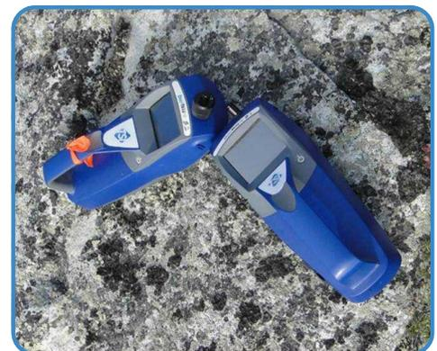
Image 1 : Les instruments utilisés pour mesurer la concentration de particules fines en suspension dans l'air. (Photo : W. Chen)
