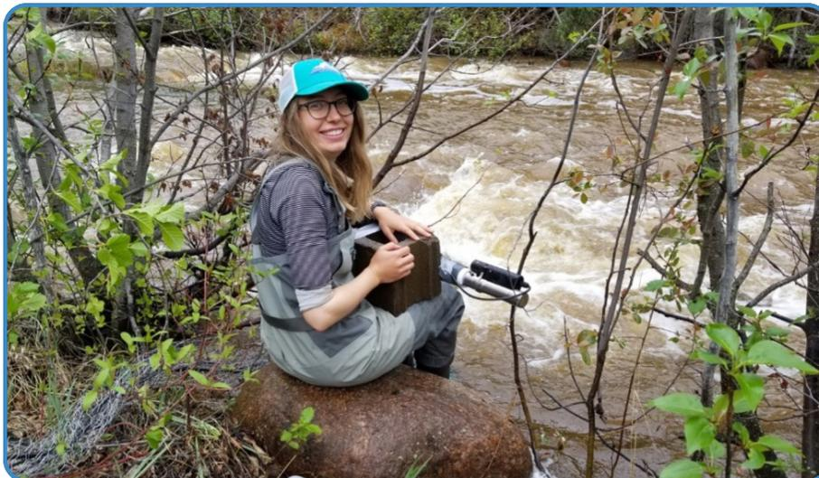
Figure 2. Lauren Thompson (candidate au doctorat à l'Université de l'Alberta) installant des capteurs pour analyser la qualité de l'eau au ruisseau Smith, près de Wrigley. Crédit photo : D. Olefeldt
